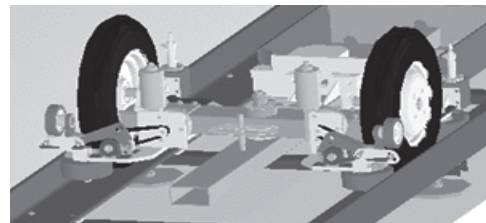
Figure 3 : vue du système de guidage sur le rail
