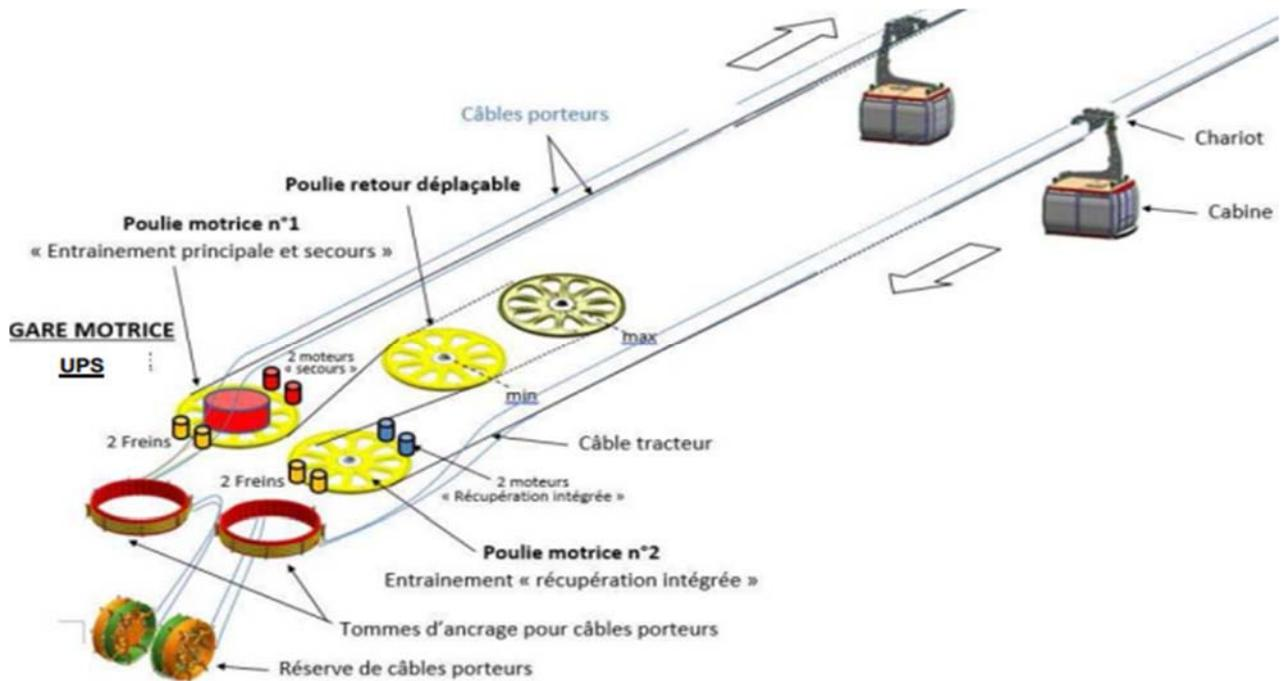
La poulie motrice qui entraîne le câble tracteur possède un diamètre de 4,55 mètres.
