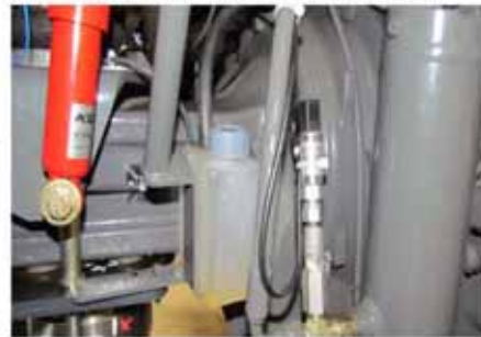
Cadre de mesures des chargement tracteur / charrue
