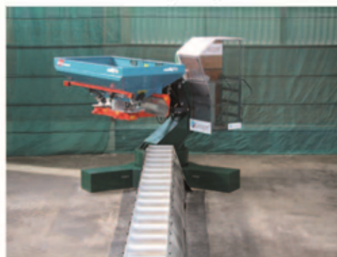
Cemib : banc rotatif d'évaluation des performances d'épandage des engrais minéraux
